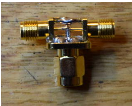
1x SMA-Stecker und 2x SMA-Buchse.
