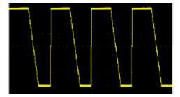
SOURce1:FUNCtion PULS SOURce1:FUNCtion:PULSe:TRANsition:LEADing 0.00000004 SOURce1:FUNCtion:PULSe:TRANsition:TRAiling 0.000001 SOURce1:FUNCtion:PULSe:WIDTh 0.000003 SOURce1:FREQuency 200000 SOURce1:VOLTage 3 OUTPut1 ON
