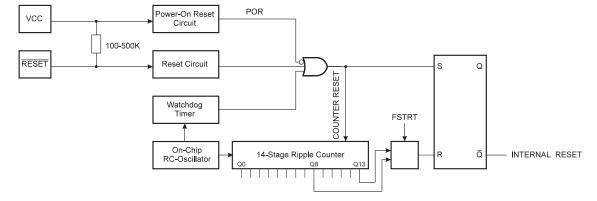
Figure 26. Reset Logic
